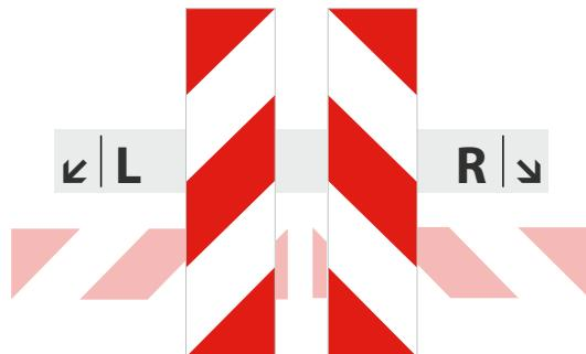
Achten Sie bei der Auswahl der Warnmarkierungen darauf, dass sich **linksweisend** und **rechtsweisend** immer auf die **vertikale Ausrichtung** bei der Anbringung bezieht. Für die **waagerechte / horizontale** Anbringung der Streifen bitte untere Grafik beachten.
